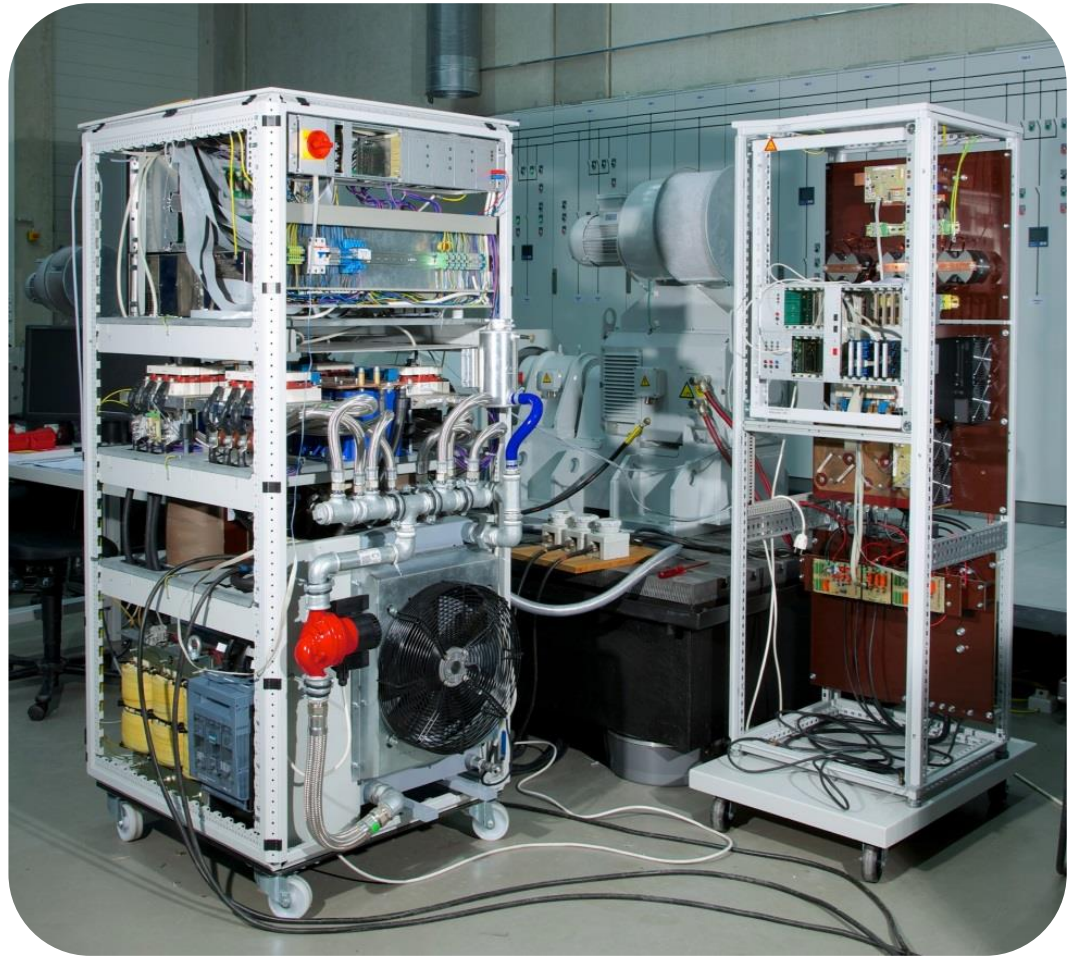
Umrichter mit vier Drehstrombrücken und DSP-System
