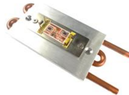
Siliziumkarbid-Testmodul vor der thermischen Charakterisierung
